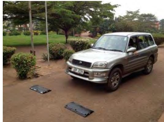
写真 3-18 ハンプを利用したキャリブレーションのデモンストレーション
