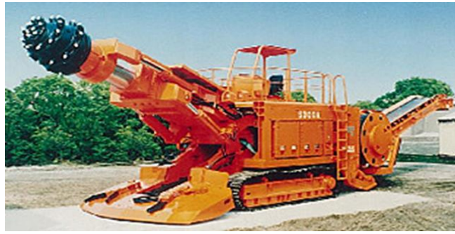
機械掘削:ロードヘッダー
