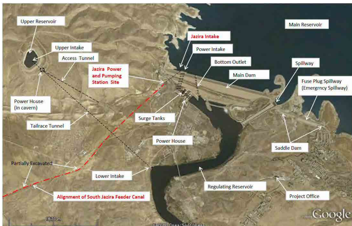
図 3.6-1 モスルダム の 主 要 構 造 物 の 配 置
