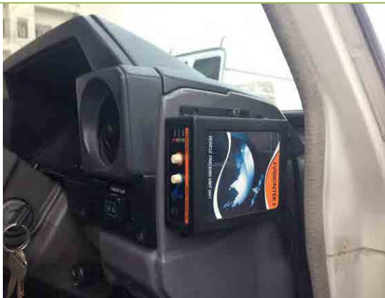
救急車には GPS 発信機が搭載されている。HHC は GPS からの電波を受信し、各救急車の位置情報を統括、管理する。
