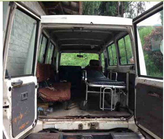
セフェル BHU-Ⅱ へ配備予定の救急車。2001 年に我が国の無償資金協力で供与。患者コンパートメントは床が腐食で割れ、同乗者シートは腰かけ部分が抜け落ちている。
