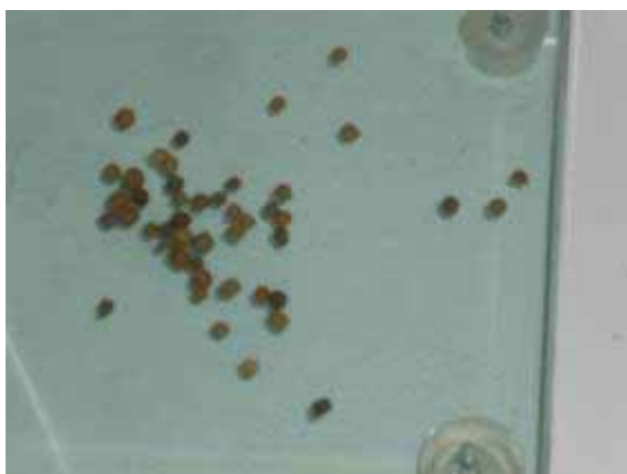
⑤周行下水処理場（嫌気・好気ろ床法） 中国製セラミックろ材
