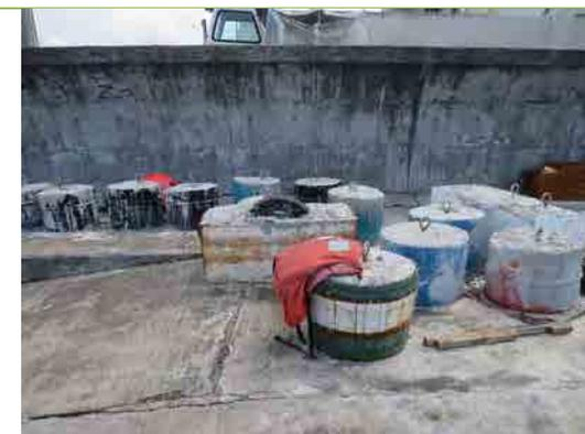
写真-6: 現地製作の FAD (地元漁民が無許可で製作・設置、写真は地元漁民製作のアンカー)。
