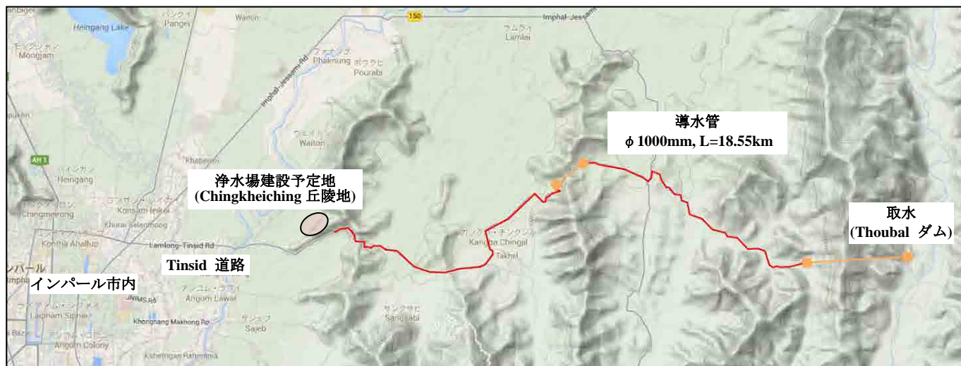
図 5.9 Chingkheiching 浄水場建設予定地
