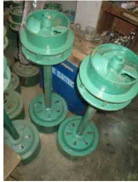
図 20 量販型のプロペラ式水車 (中国製)
