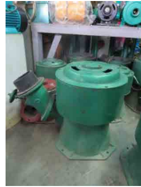
図 21 量販型のターゴ式水車 (中国製)
