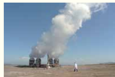
Essai de production de vapeur géothermique à Menengai, au Kenya
