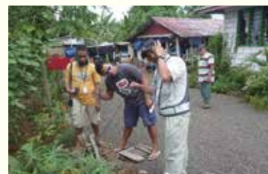
Dispositif de détection acoustique des fuites avec un compteur
