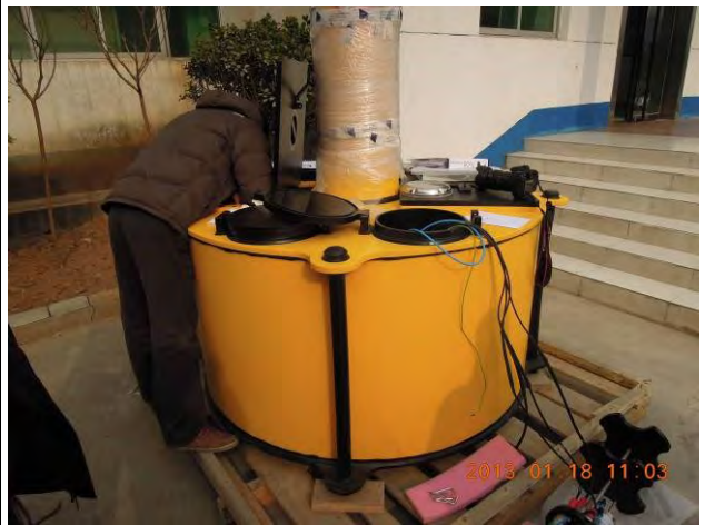
写真-16 設置予定のプイ式水質観測装置 2013年1月18日 黒河総ステーション
