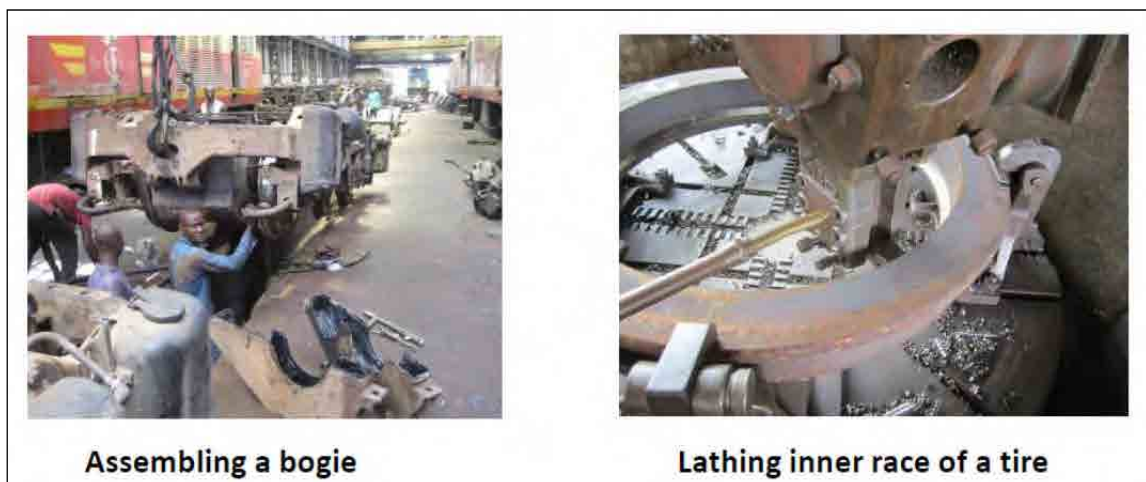
写真 2.3.52 車両保守作業：車両工場
