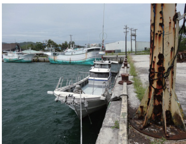
⑨漁業訓練実習船“HOKUTO” （全長：12.5m、全幅：3.1m、トン数：4.0t）
