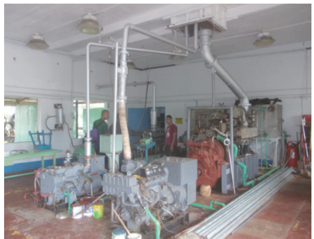
機関科実習室〔供与された機関（エンジン）と 島間連絡船から取外して設置した機関が並ぶ〕
