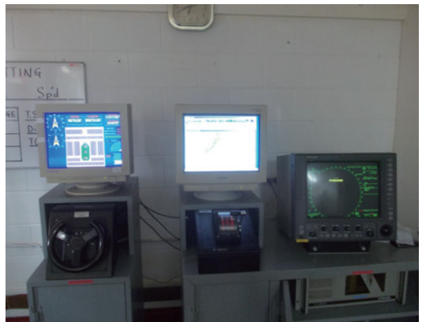
④レーダーシミュレータ
