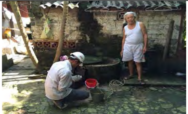
Ph-24 phường Tiên An Lấy mẫu và phân tích nước ngầm (nước giếng)
