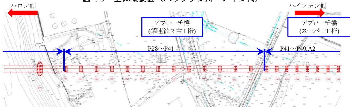
図 5.9 全体概要図 (バックダン川 メイン橋)
