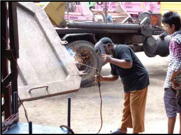
EGAP ワークショップ 収集車両整備・修理状況(北ダッカ市)
