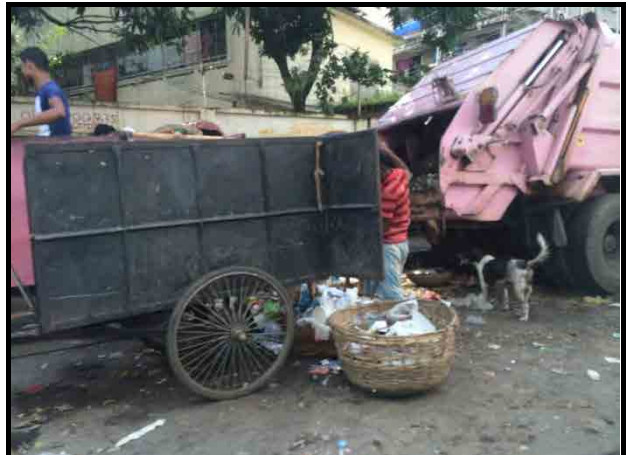
一次収集業者によるコンパクターへの積替作業 (南ダッカ市)
