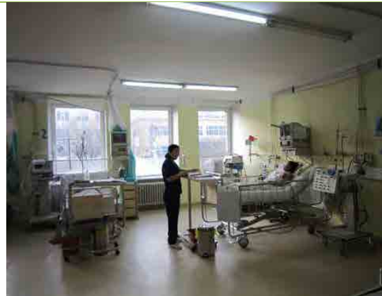
写真-9: ウランバートル市中心部にある国立第1病院のICU。建物側で空気の清浄度を保つ設備はなく、簡易な医療機器で対応している。
