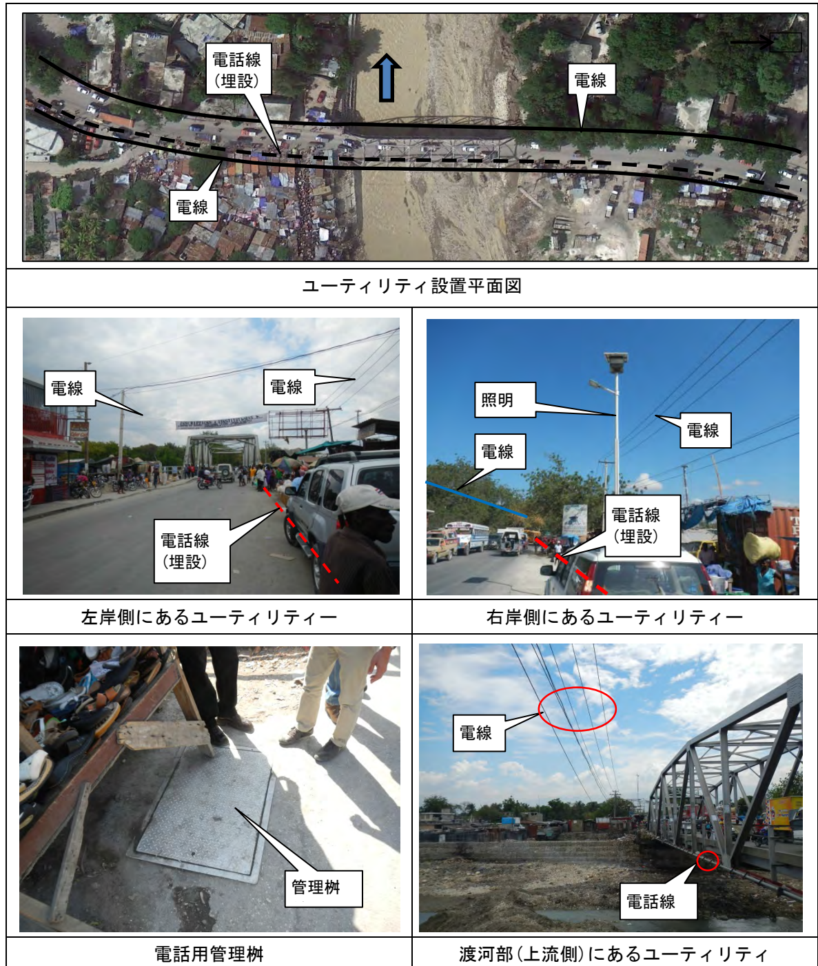
資料 図-1 クロワデミッション橋梁周辺部における支障物件
