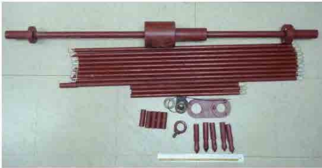
写真 2.2.5 使用機器 (Dynamic Cone Penetration)
