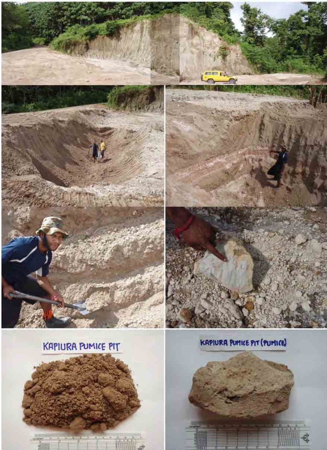
写真 2.2.4 試料採取状況および採取試料 カピウラピット
