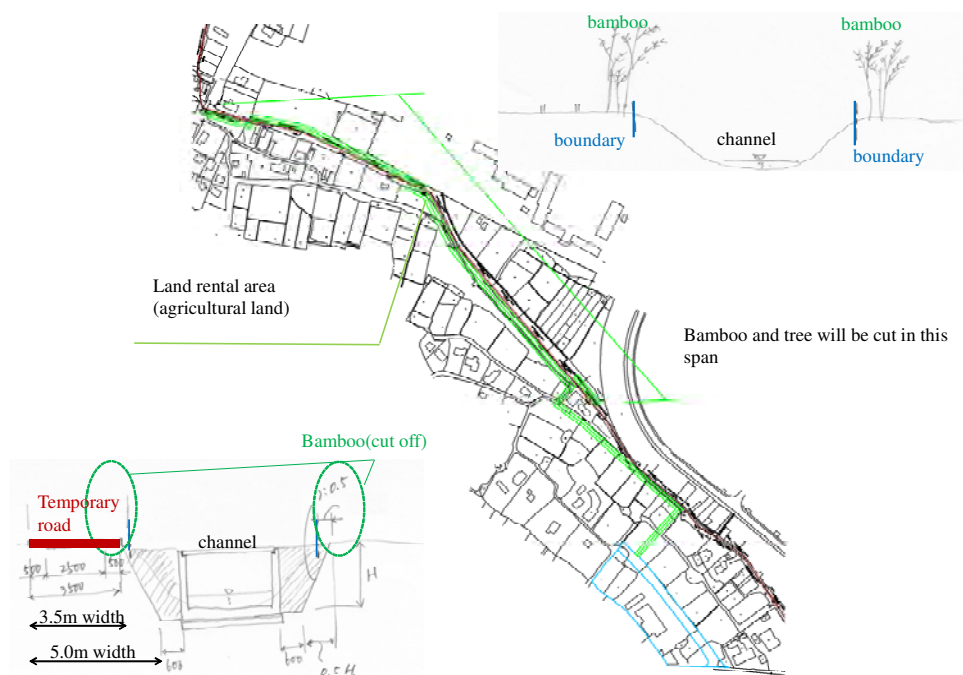
Hình 2.3.9-1 Đường tạm, bãi chứa vật liệu và chặt bỏ tre để nâng cấp kênh cầu Nhật Bản
