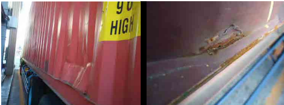
図 6.2-6 軽微なダメージ（出典：上組神戸コンテナターミナル）
