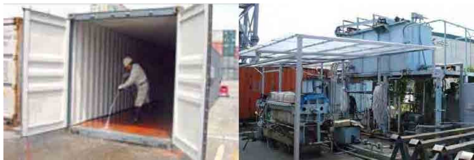
図 6.2-8 コンテナ洗浄と浄化装置 (出典：上組神戸コンテナターミナル)
