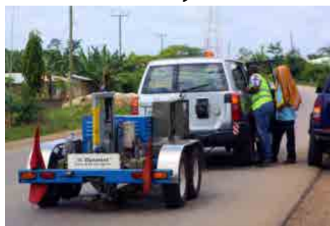
FWD 計測機器および計測実施の様子
