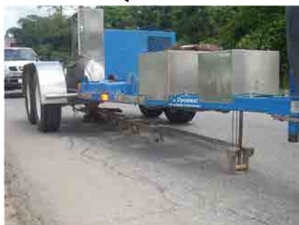
FWD 計測機器および計測実施の様子
