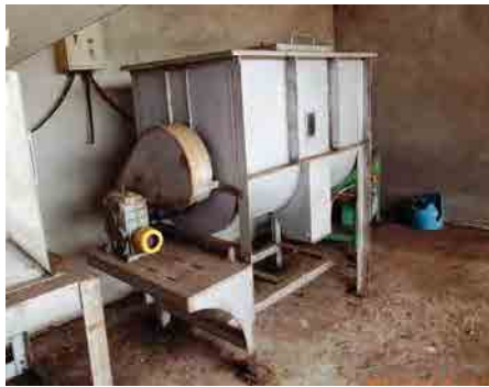
写真-9：NADC の既存飼料製造用ミキサー（故障のため使用されていない）
