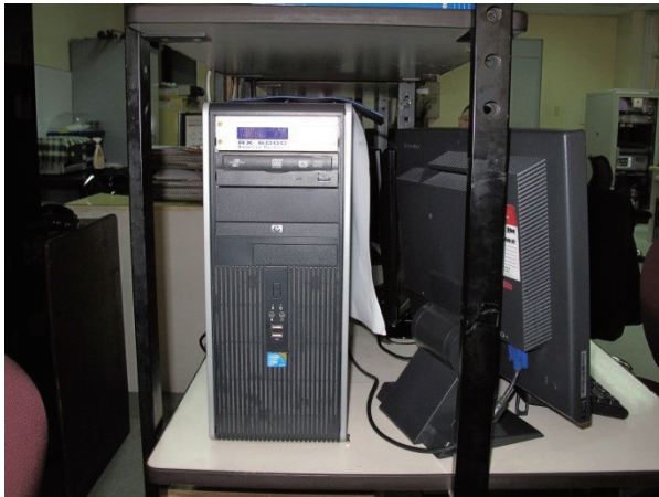
MTSAT 受信装置 (PAGASA 予算でオーストラリア気象局が設置)
