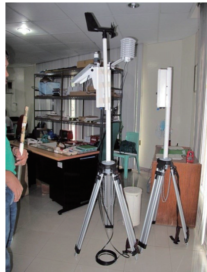
気象測器の可搬型検定装置
