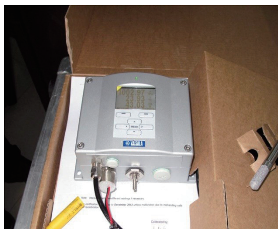
気圧計の移動用国内準器
