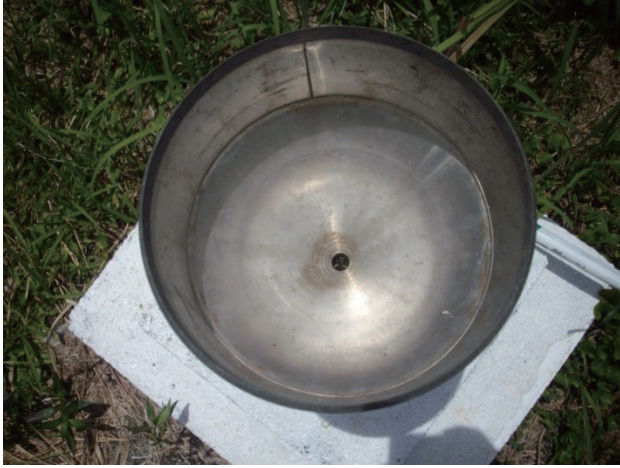
虫が入った転倒マス型雨量計
