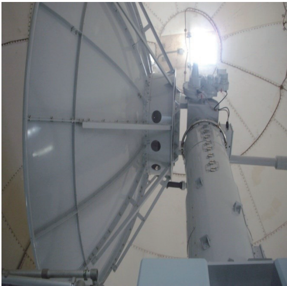
アンテナ (直径 5m)
