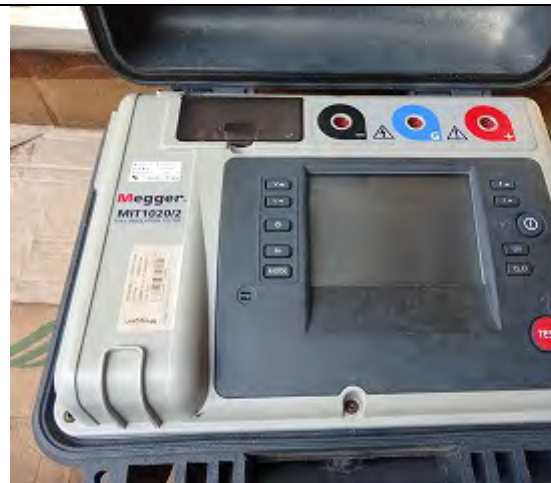
Insulation tester (Megger MIT 1020/2)
