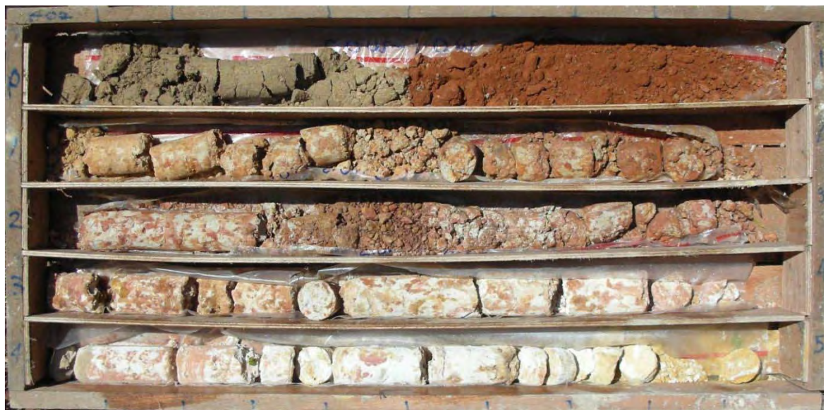
図 3-2-5-8 D-2 表層のラテライト土壌と風化帯
