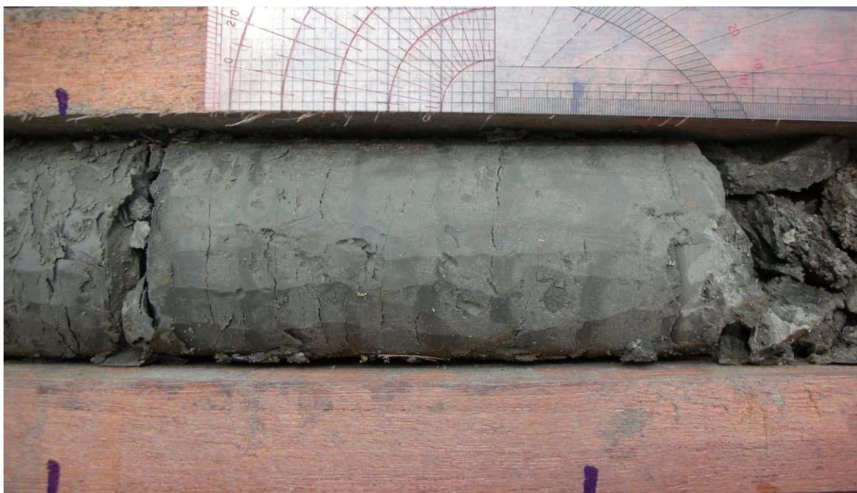
図 3-2-5-13 D-2 249.4~249.55m 付近の粘土とシルトの細互層（ほぼ水平）
