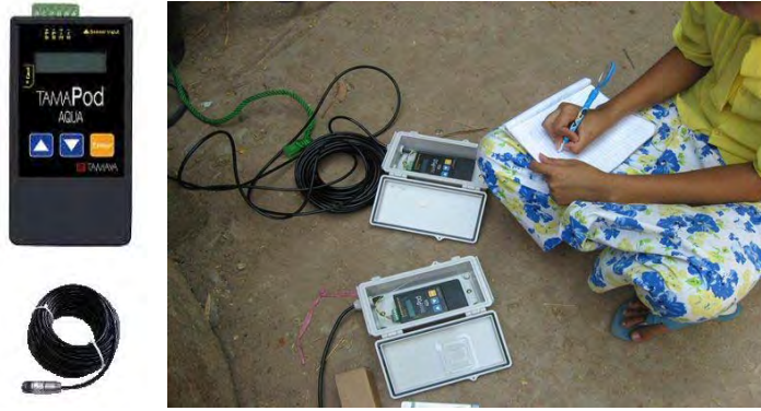
図 3-2-13-4 水位測定に使用した自記水位計
