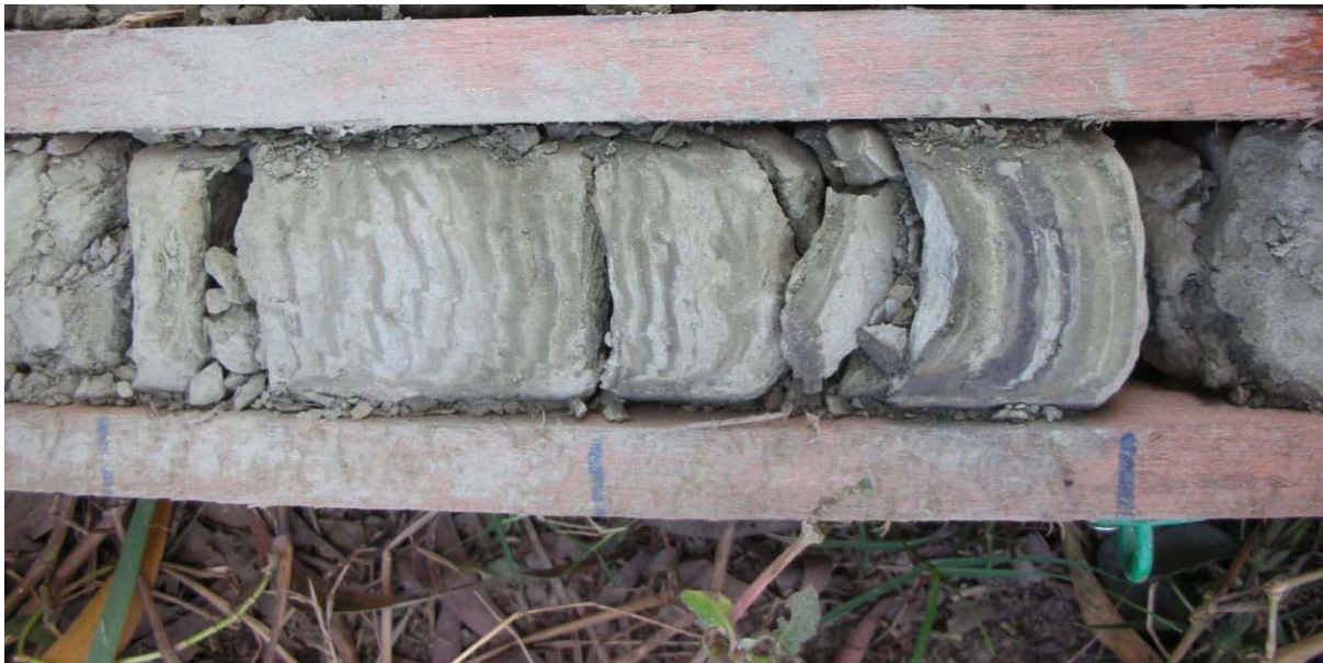
図 3-2-5-15 D-4 9.3～9.5m 付近のシルトと微細粒砂の細互層 （ボーリングのトルクにより乱れている）
