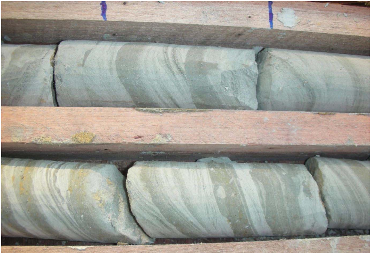
図 3-2-5-10 D-2 95.5～96.5m 付近のシルトと微細粒砂の半固結細互層
