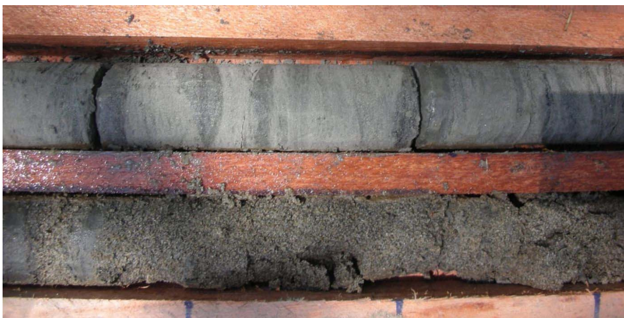
図 3-2-5-19 D-4 深度 223.5-224.5 付近のシルトと微細砂の互層と弱固結の砂岩
