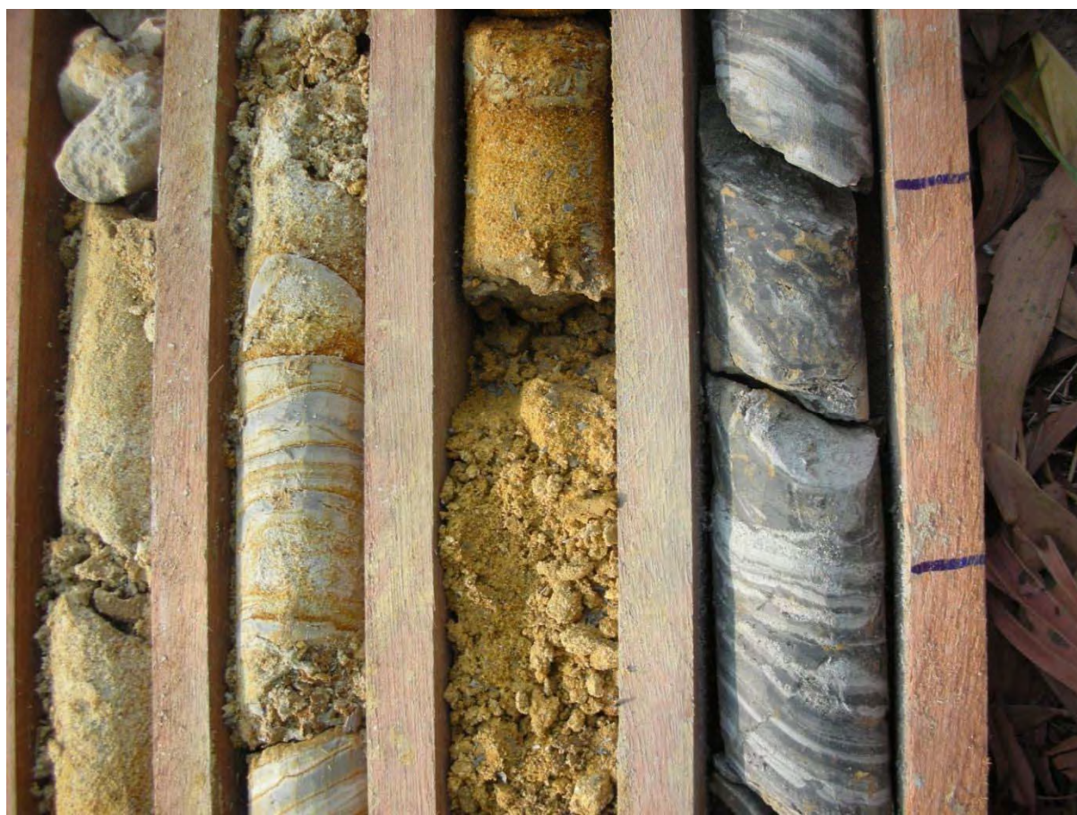
図 3-2-5-9 D-2 86.5～89.5m 付近の酸化鉄による褐色化風化帯
