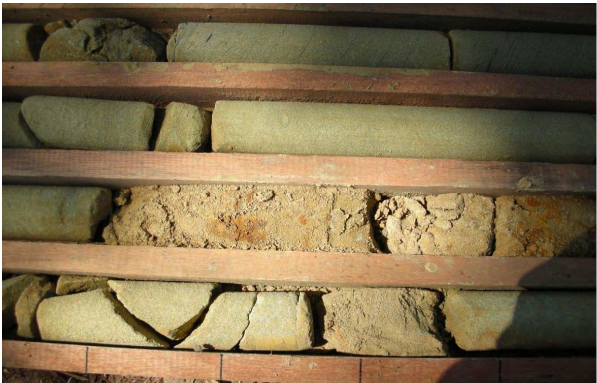
図 3-2-5-11 D-2 131.5～134.5m 付近の硬質砂岩と褐色低固結砂岩層
