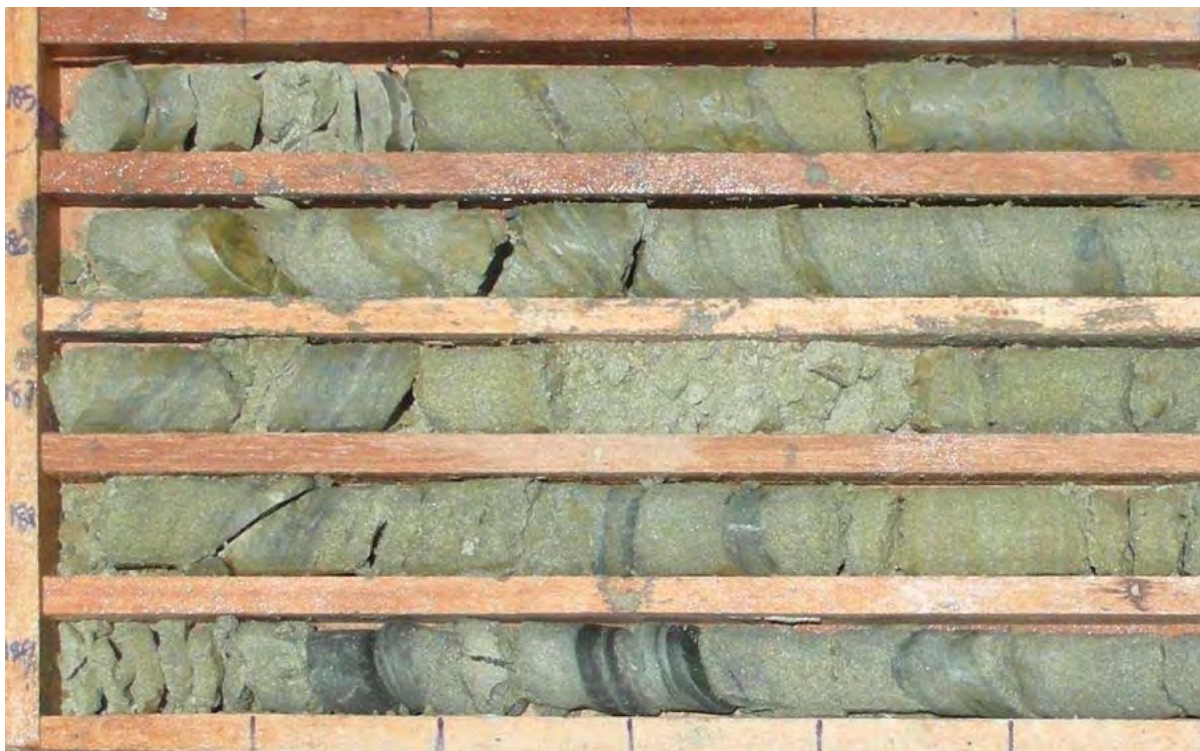
図 3-2-5-12 D-2 186.0~189.5m 付近の低固結（指圧で潰れる）砂岩層
