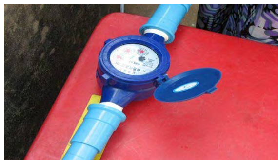
図 3-2-13-3 浅井戸の揚水に使用したポンプ 図 3-2-13-2 揚水量測定に使用した積算流量計
