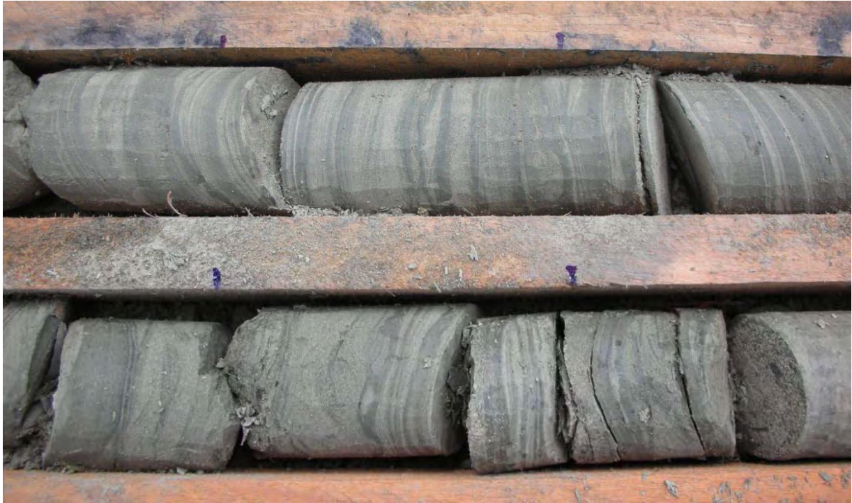
図 3-2-5-14 D-2 255.5～256.5m 付近のシルトと微細粒砂の細互層（約 15 度傾斜）
