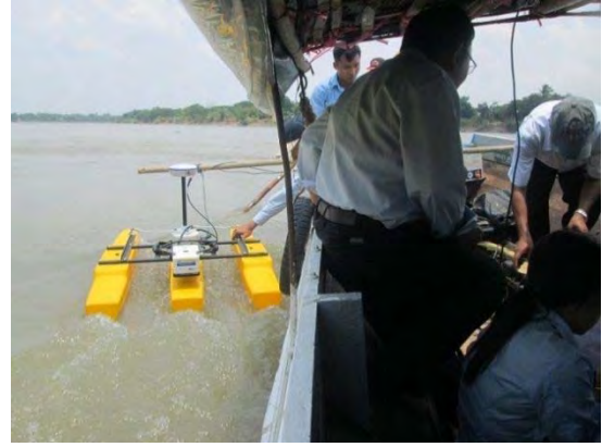
ドップラー流速計による観測状況（バゴー川）。2014年5月撮影
