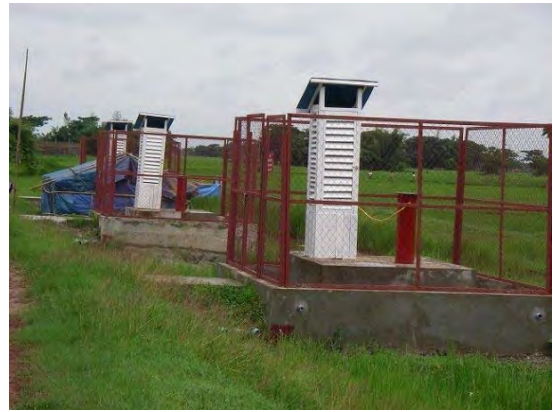
試験井戸掘削後の地下水位観測施設設置状況 (D-3 サイト)。 2013 年 10 月撮影
