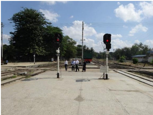
写真-9： ヤンゴン中央駅付近の幹線とヤンゴン環状線は色灯信号式である。信号機構の現示はLED化されている。
