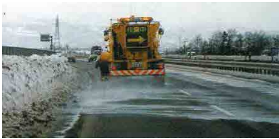
<図 10-1>日本の凍結防止剤散布作業の実施状況(左)及び凍結防止剤散布車の概要図(右)
