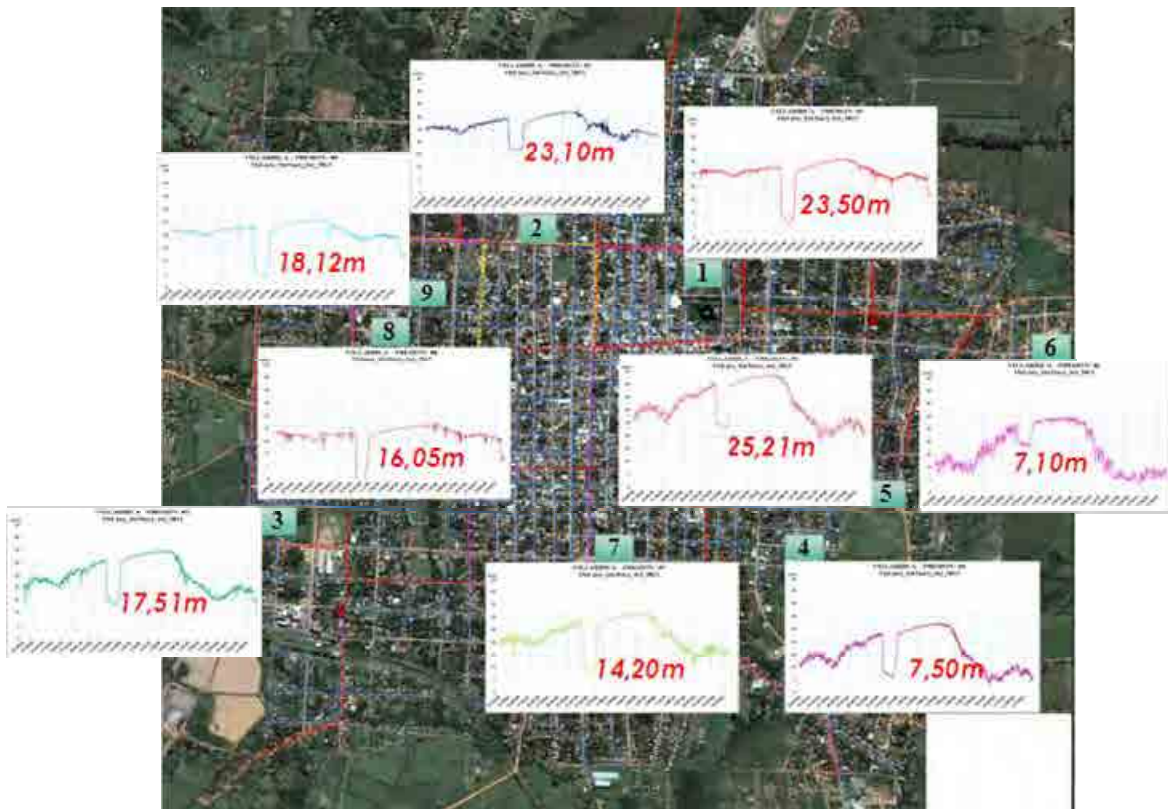
Figura 2.4.8 Distribución de la presión de agua en las llaves en la ciudad de Villarrica
