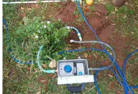
Verificación de la precisión de medidor domiciliario
