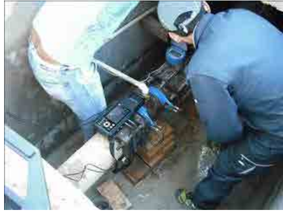
Descarga de datos de caudal y presión de agua
