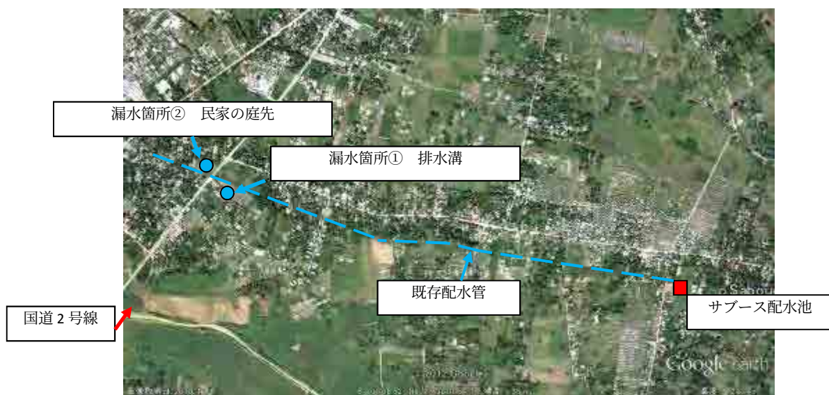
図 3.1 サブス配水池下流の漏水箇所
