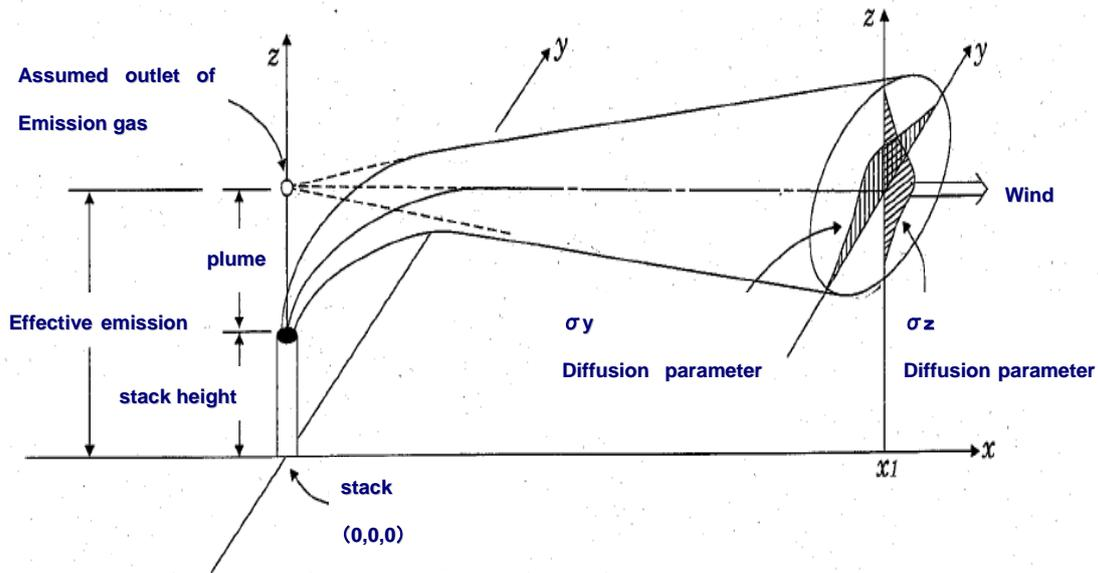
**Figure13.6-3 Gaussian Diffusion Model Diagram**
