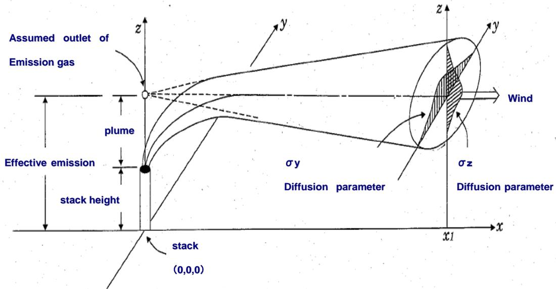
**Figure13.6-3 Gaussian Diffusion Model Diagram**
