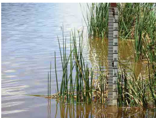
水位観測所番号:3J2 JIPE 湖の水位を観測するために、サファリキャンプ内に設置された水位観測地点
