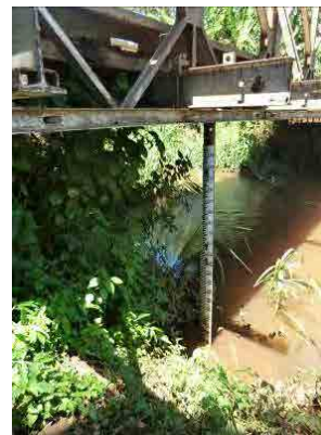
水位観測所番号:3J16 Lumi 川の水位を測定。橋梁の下に設置
