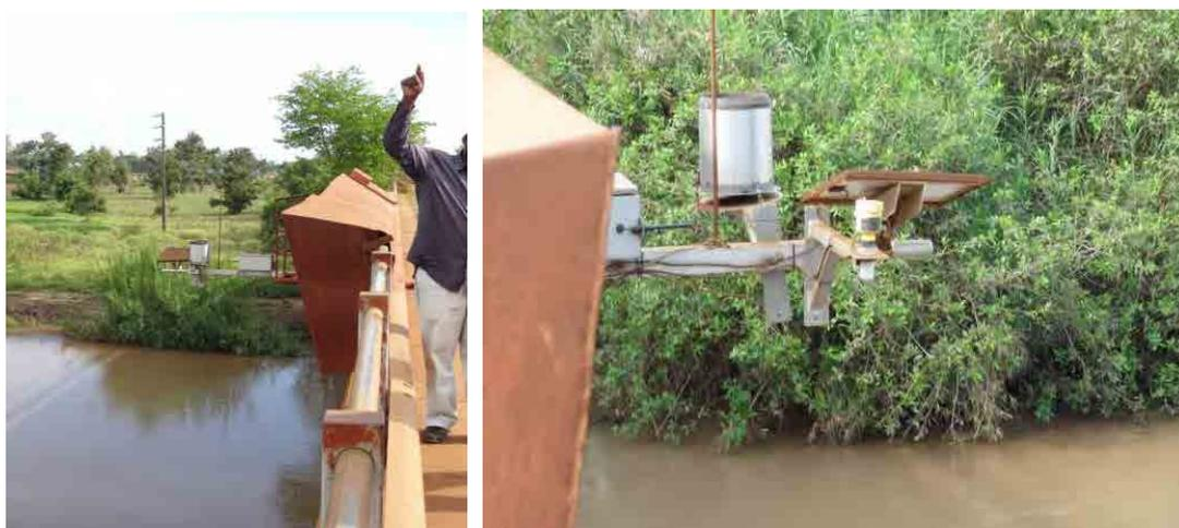
写真 1.5-5 Budalangi における破壊・盗難防止カバー付の水文・気象自動観測機器
