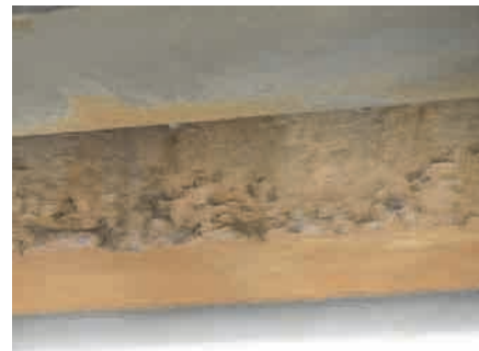
Présence de soufflures de fonte
