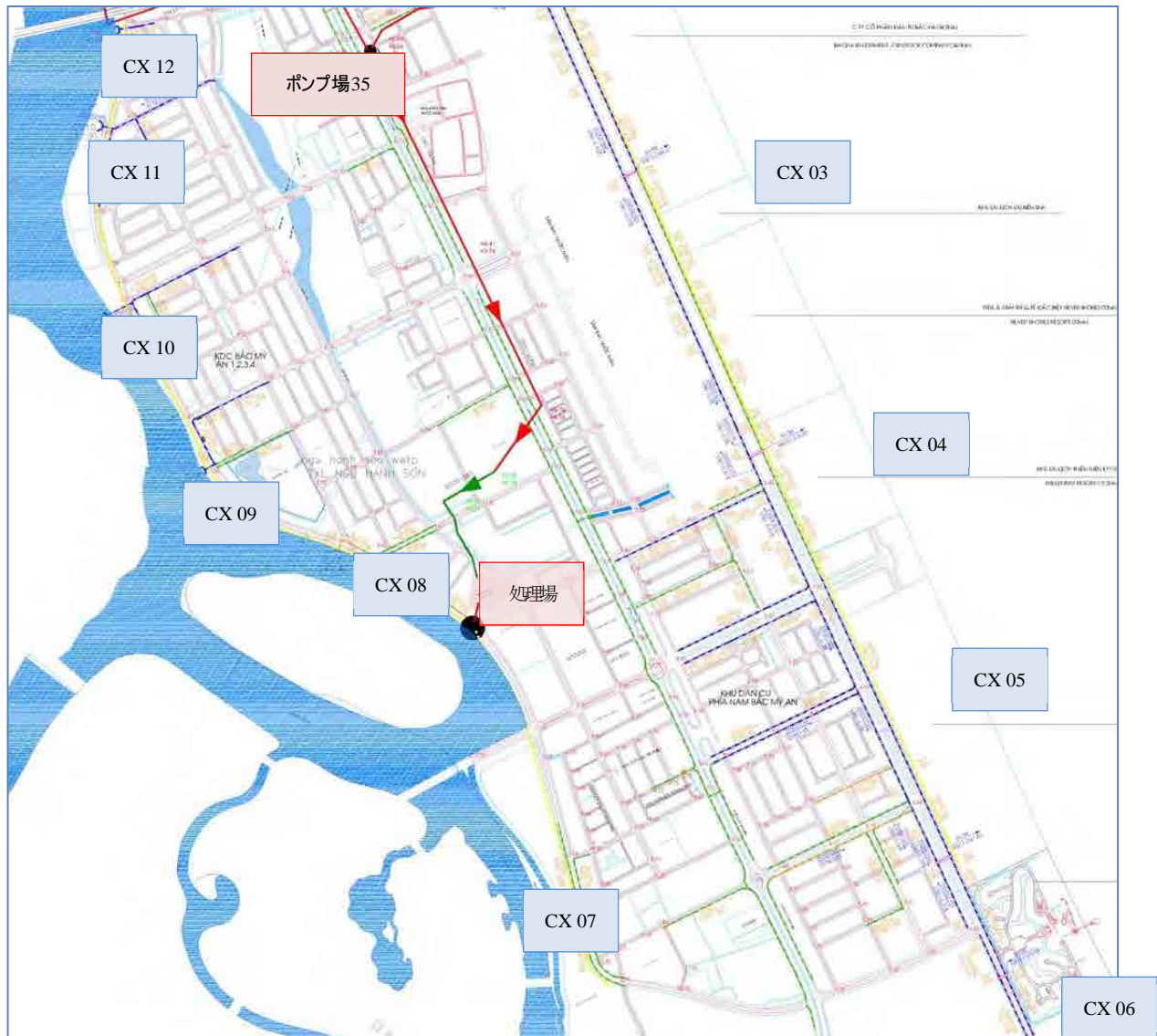
図 2.2 合流式下水道吐口と遮集管位置 (南側)
