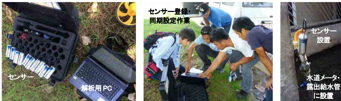
写真-3.5.2 ZONSCAN 820 による漏水調査
