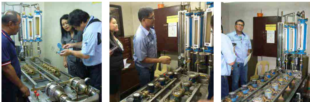
写真-3.2.6 水道メータ試験室(左：設置前、中・右：計測中)
