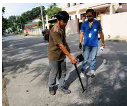
写真-3.1.1 地上漏水発生箇所(左)、地下漏水(中・右)の調査 [3-1]
