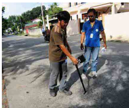
写真-3.1.1 地上漏水発生箇所(左)、地下漏水(中・右)の調査
