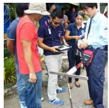
写真-3.1.1 地上漏水発生箇所(左)、地下漏水(中・右)の調査 [3-1]
