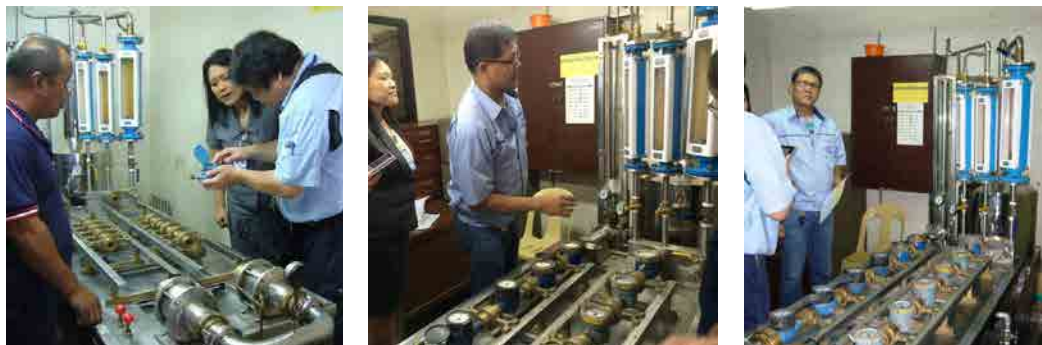
写真-3.2.6 水道メータ試験室(左:設置前、中・右:計測中) [3-11]
