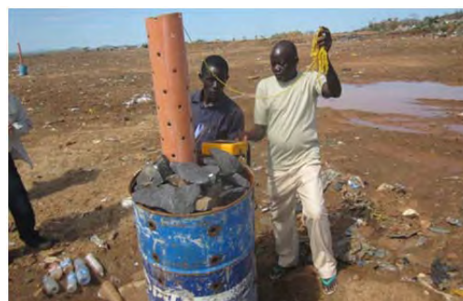
図 3-13 CP によるランドフィルガス測定
