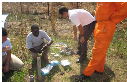
図 3-12 CP による地下水質測定
