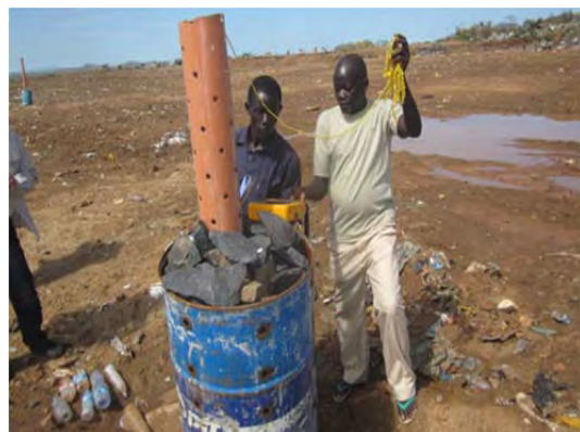
環境モニタリング (ランドフィルガスの測定)
