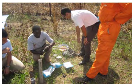
図 4-22 C/P による地下水水質測定
