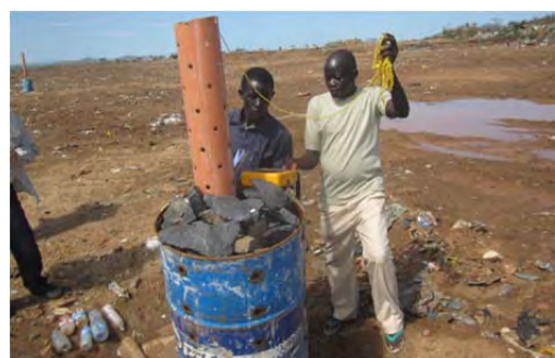
図 4-23 C/P によるランドフィルガス測定
