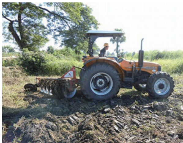
AMD インド製トラクターによる ハローディスクプラウ耕 (Shwebo タウンシップ／2013 年 11 月 12 日)
