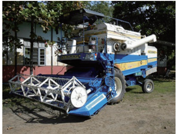
インド製コンバイン、 車輪式で湿田には対応できない (Nattalin AMS / 2013 年 10 月 25 日)
