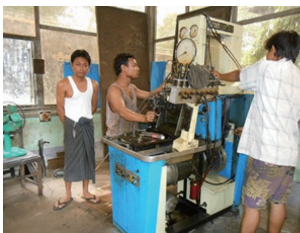
インジェクションポンプの調整・点検作業 (AMD ベースワークショップ、Yangon / 2013 年 11 月 25 日)
