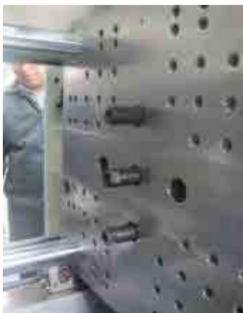
Fig. 3.18 Émbolos de eyección
