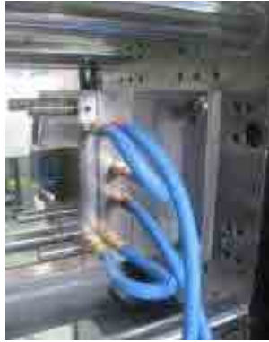
Fig. 3.11 Canales de enfriamiento
