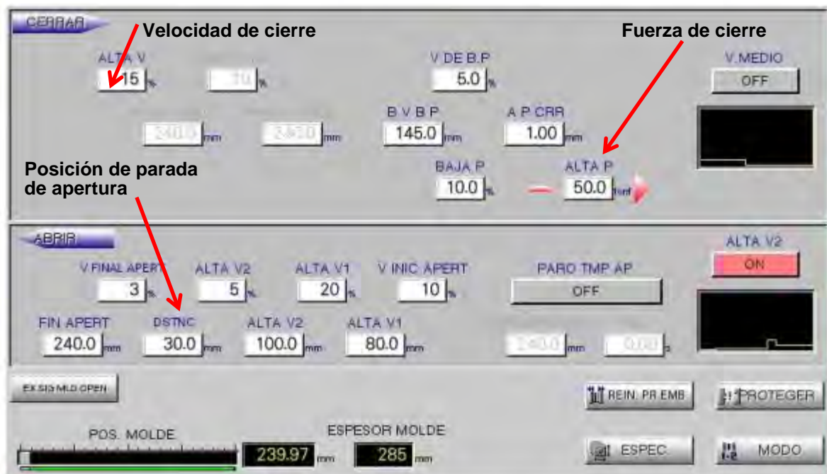
Fig. 3.54 Pantalla para cerrar y abrir el molde
