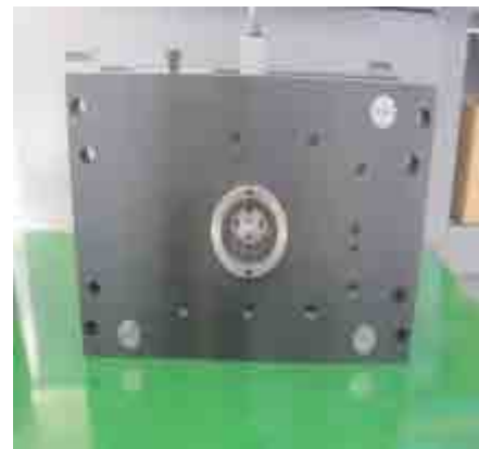
Fig. 3.6 Anillo centrador molde
