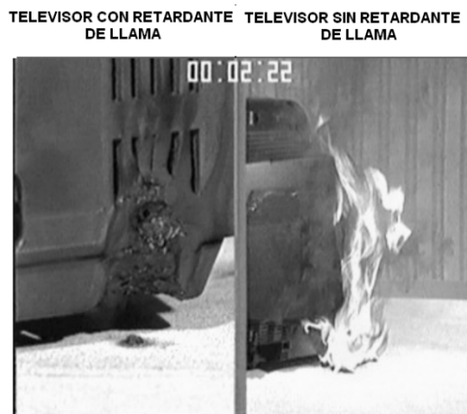
Foto. Ejemplo de aplicación de aditivo con retardante de flama.( http://www.proseguridad.com.ve/ )
