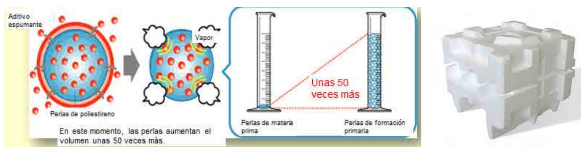
Imagen. Proceso de formación de espuma PS, M1-2.4
