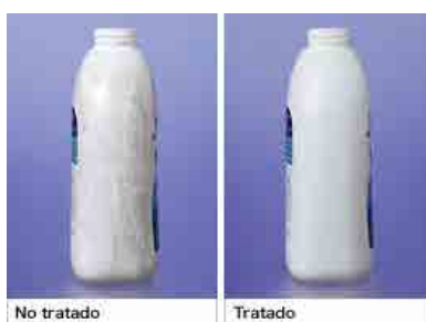
Foto. Los efectos de agentes antiestáticos en productos plásticos (ejemplo de resultados de prueba en camara sucia)
