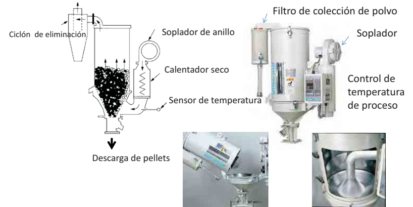
Figura-10: Diagrama de secado de la secadora tipo tolva Editado por Sociedad Académica de Macromoléculas, Base de la transformación del plástico
