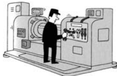
Figura-10. Control en diferentes puntos: Herramientas para el cambio del molde colocadas en la máquina.
