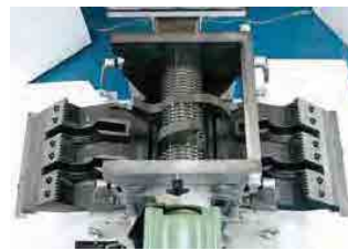
Limpieza fácil: Se puede abrir completamente sin herramientas.
