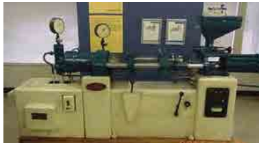
Máquina de inyección manual hidráulica con el sistema de émbolo: año 1957
