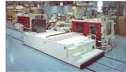
Fig. 1 Sistema de cambiador completamente automático de moldes
