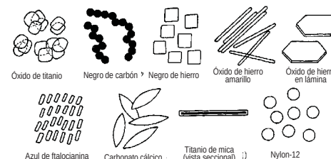
Figura-8 Modelos de forma de las partículas de pigmentos
