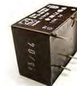
Foto 4. Pequeño transformador moldeado por Potting con epoxi. Fuente: Wikipedia, the free encyclopedia
