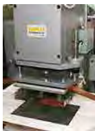
Foto-4: Contenedores flexibles de PVC y Máquina de soldadura por alta frecuencia
