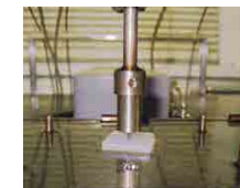
Fotos-6: Equipos de ensayos: Temperatura de deflexión bajo carga, temperatura de reblandecimiento Vicat , temperatura de presión de balón
