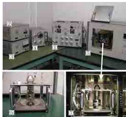
Foto-14: Equipo de medición de la pérdida dieléctrica
