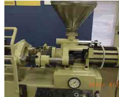
Máquina de inyección con el sistema de émbolo (horizontal): año 1957
