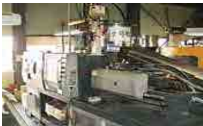
Foto 5. Máquina de inyección del material termofijo, Fuente: Takanashi Corp.
