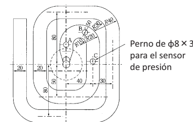
Dibujo-6: Ejemplo del molde para la medición de flujo libre
