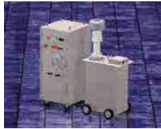
Foto-10: Equipo del ensayo de fuerza dieléctrica 100kV-10kVA
