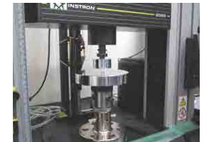
Foto-2: Ensayo de compresión
