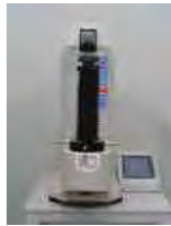
Dibujo-17: Método de ensayo de la dureza Rockwell
