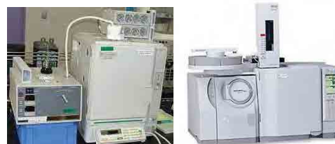
Foto-6 Vista exterior de la estructura de PyGC
