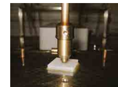
Fotos-6: Equipos de ensayos: Temperatura de deflexión bajo carga, temperatura de reblandecimiento Vicat , temperatura de presión de balón
