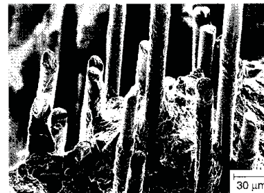
Foto-1 Superficie de fractura del plástico reforzado con fibra de vidrio (20wt%) Gottfried W.Ehrenstein : Materiales Poliméricos, p128(2001) HANSER
