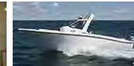
Foto-31 Cuarto de baño prefabricado y barca de pesca de resina de poliéster insaturado (UP)
