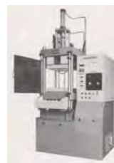
Foto 3. Máquina de moldeo por transferencia para encapsular con baja presión
