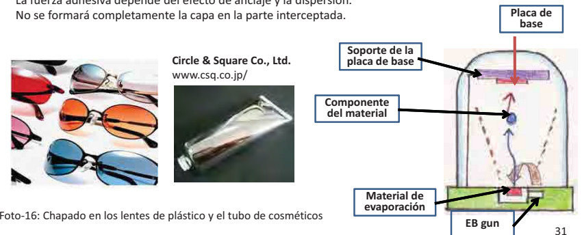
Figura-23: Principio del método de deposición al vacío
