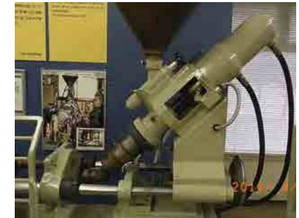
Máquina de inyección con el sistema de émbolo (inclinado): año 1963
