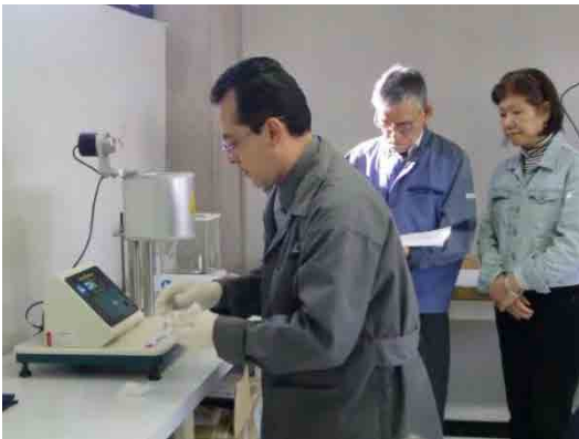
Evaluación de habilidades técnicas Medición de la velocidad de flujo de fusión (MFR)
