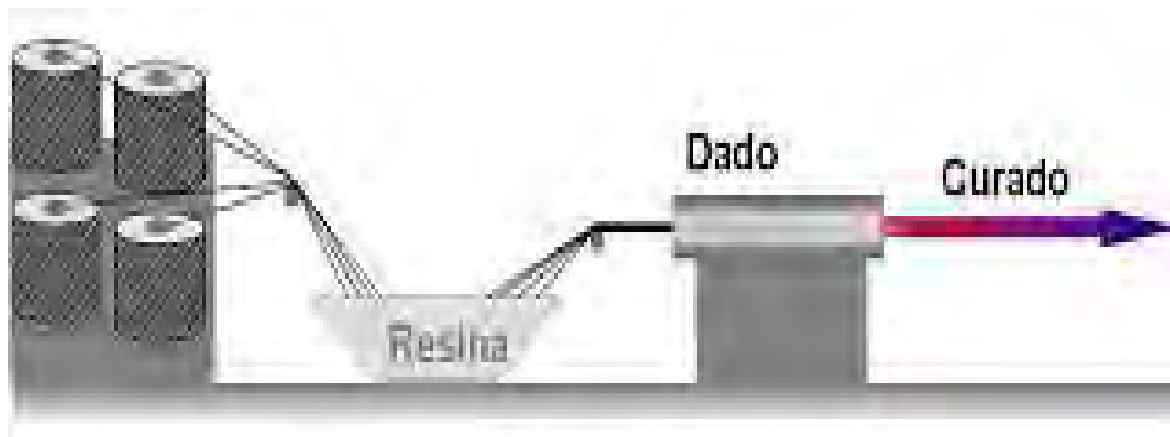
Figura 4.4 Esquema del proceso de pultrusión
