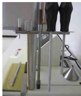
写真-1 押出式プラストメーターのツールラック
