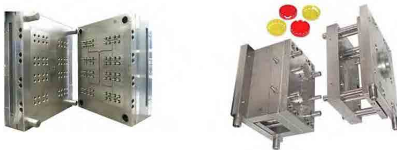
Fig.1.1 Moldes para inyección de plásticos.
