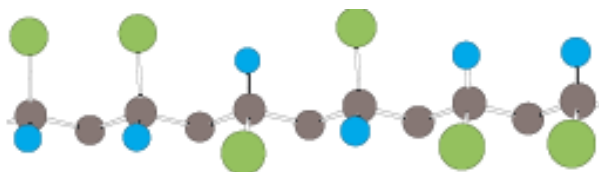
Figura 1.7 Estructura de un polímero atáctico
