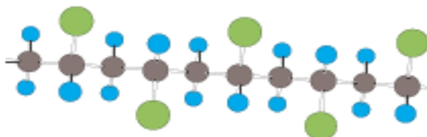
Figura 1.6 Estructura de un polímero sindiotáctico
