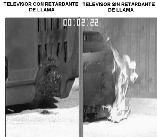
Foto. Ejemplo de aplicación de aditivo con retardante de flama.(<http://www.proseguridad.com.ve/>)
