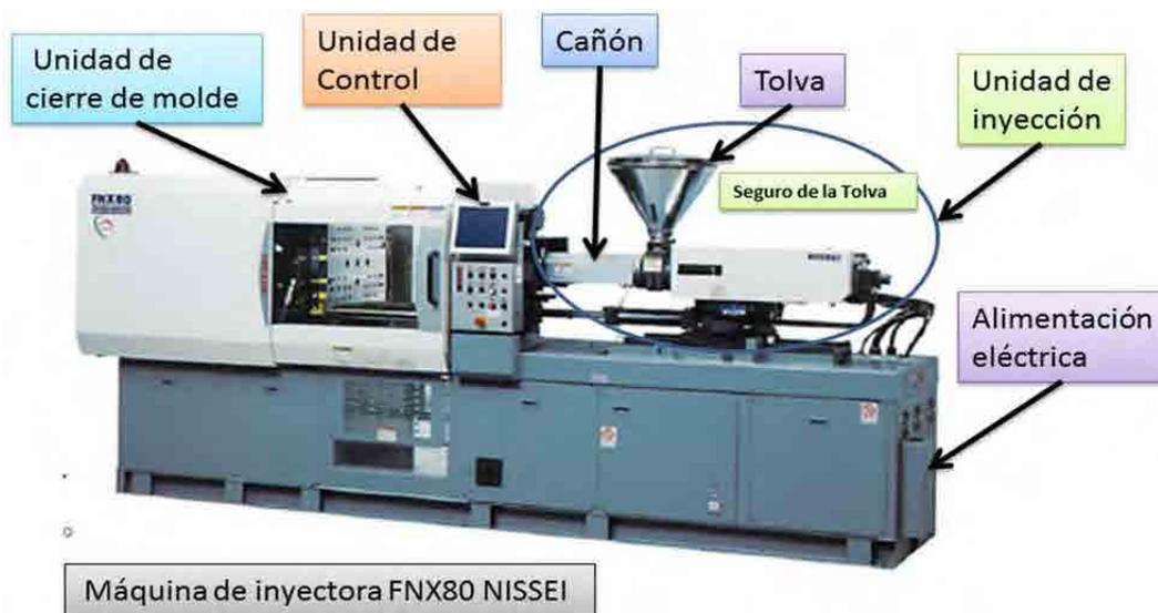
Figura: Máquina de inyección.
