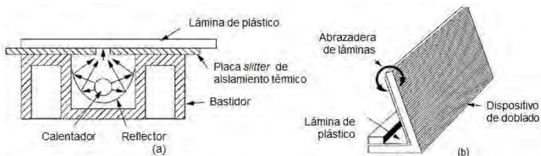
Fig.- (a) Aparato de calentamiento para doblado, y (b) dispositivo para enfriamiento)
