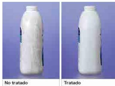
Foto. Los efectos de agentes antiestáticos en productos plásticos (ejemplo de resultados de prueba en cámara sucia)
