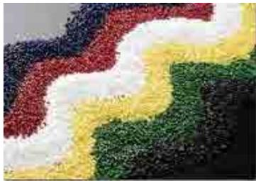
Imagen. Pellets de Masterbatch
