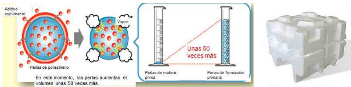
Imagen. Proceso de formación de espuma PS, M1-2.4
