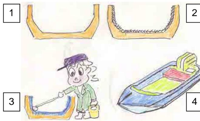
Figura: Proceso de Hand Lay Up Molding
