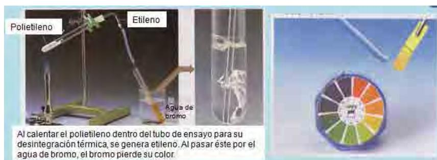
Imagen: Desintegración de plásticos y papel universal de prueba de pH
