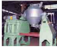
二重円錐型混合機の構造真空乾燥機。 Double cone type mixer. Vacuum conical dryer
