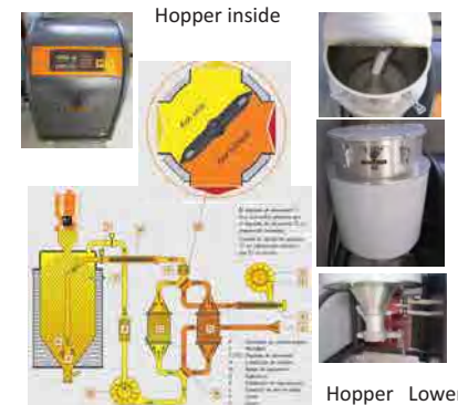
図-12 乾燥回路 本間精一:基礎から学ぶ射出成形の不良対策、P46丸善(2012)
