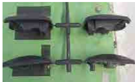
写真1 被粉碎物と 混合前の樹脂形状
