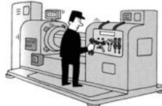
図-10 分散管理、 機械に取り付けられた 段取り工具
