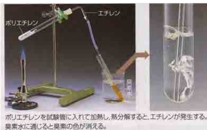
写真-2 プラスチックの分解と万能pH試験紙
