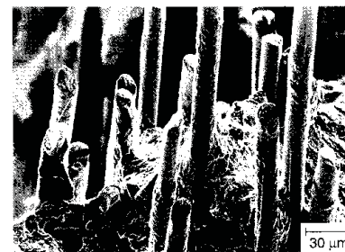
写真-1 ガラス繊維強化PP (20wt%)の破壊面 Gottfried W.Ehrenstein : PolymericMaterials , p128(2001) HANSER
