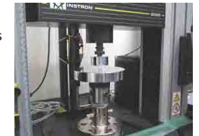
写真-2 圧縮試験
