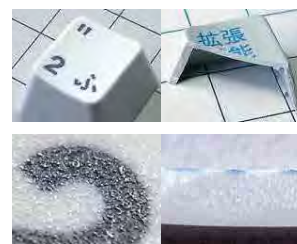
写真-13 含侵印刷適用例
