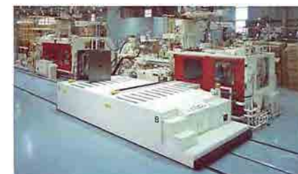
図1 全自動金型交換システム
