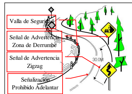
Figura 16.2.1 Plan de Combinación Típico de Instalaciones de Seguridad Vial en Lugares Peligrosos
