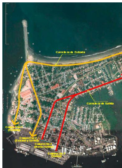
Figura 19.1.2 Plan de Regulación Propuesto para la Calle de Acceso al Puerto
